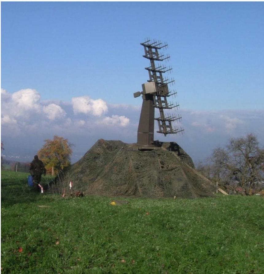
Abbildung 32: Peilantenne der Anlage P-760 getarnt.
