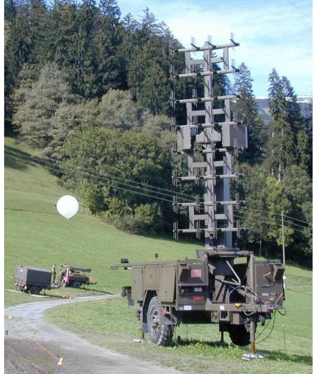
Abbildung 35: Peilantenne einer Anlage P-760.
