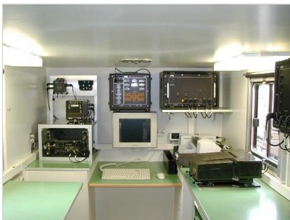
Abbildung 29: Innenansicht der Auswerteeinheit P-763+ mit Computer, INTAFF und Drucker.
