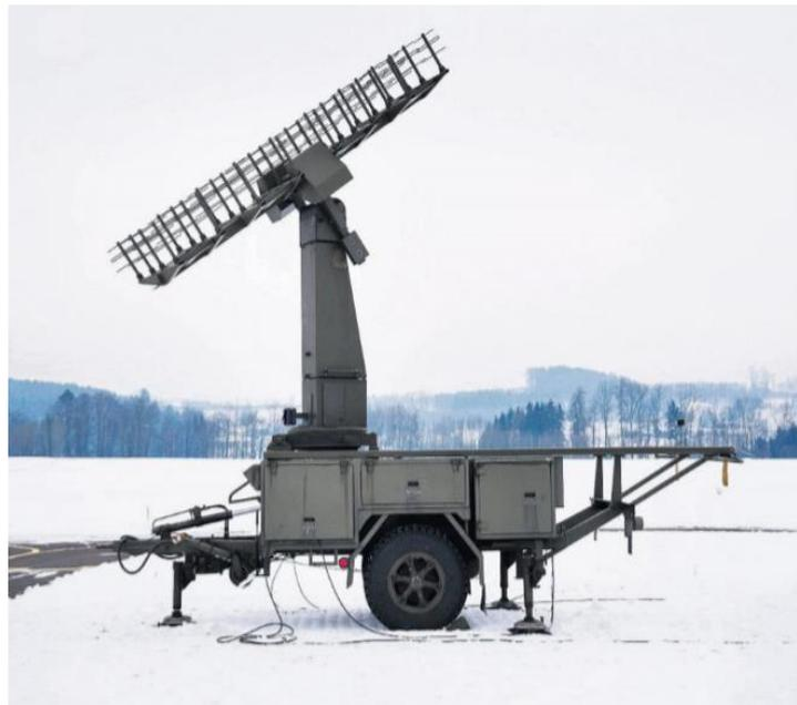
Abbildung 13: Antenne der aus den sechziger Jahren stammenden Anlage P-760.
