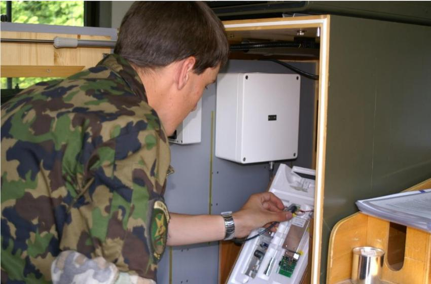
Abbildung 33: Radiosondeur bei der Vorbereitung einer Radiosonde SRS-400.
